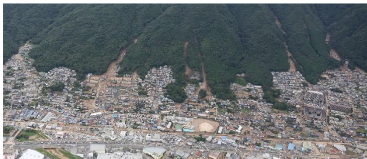
阿武山からの多くの細い谷から土石流が民家を襲い、手前の JR 可部線や国道 54 号線まで迫った
